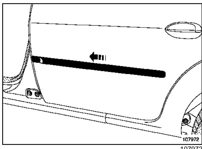
Снимите декоративную планку, сдвигая ее к передней части автомобиля.
