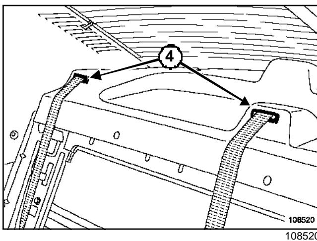
Отсоедините направляющие ремня (4), отжав пружинные защелки.
