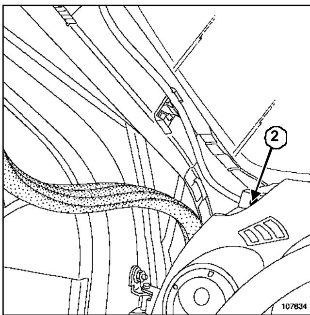
Снимите болты (2) крепления с каждой стороны приборной панели.
