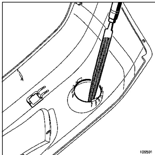
Закончите обработку полукруглым напильником.
