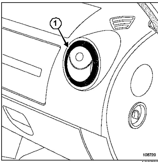
С помощью плоской отвертки снимите декоративное кольцо (1) вокруг сопла вентиляции.
