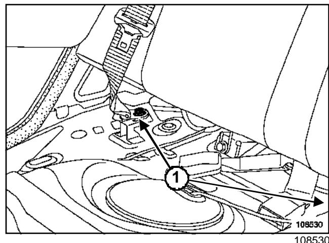
Отверните болты (1) крепления ремней безопасности
