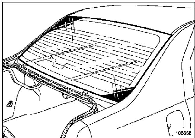
Наклейте защитную ленту по периметру проема заднего стекла и обивки крыши.
