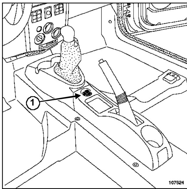
Снимите переключатель регулировки
