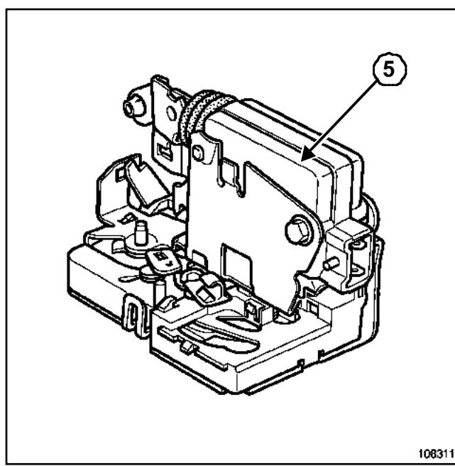
Снимите электродвигатель привода замка (5) (в зависимости от уровня комплектации).
