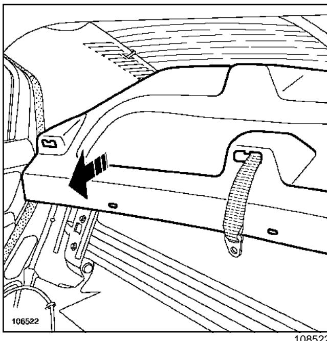
Снимите обивку задней полки.
