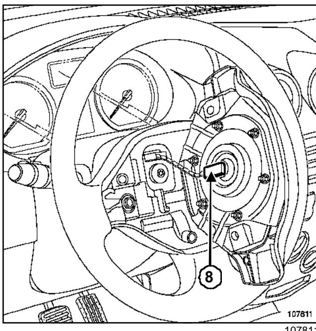
Разъедините разъем блока подушки безопасности (8) (в зависимости от комплектации).
