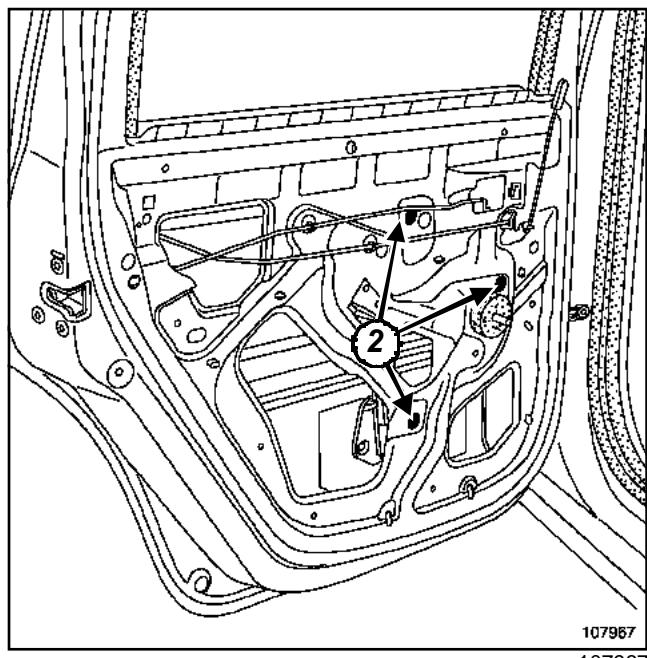
Отверните гайки (2).
