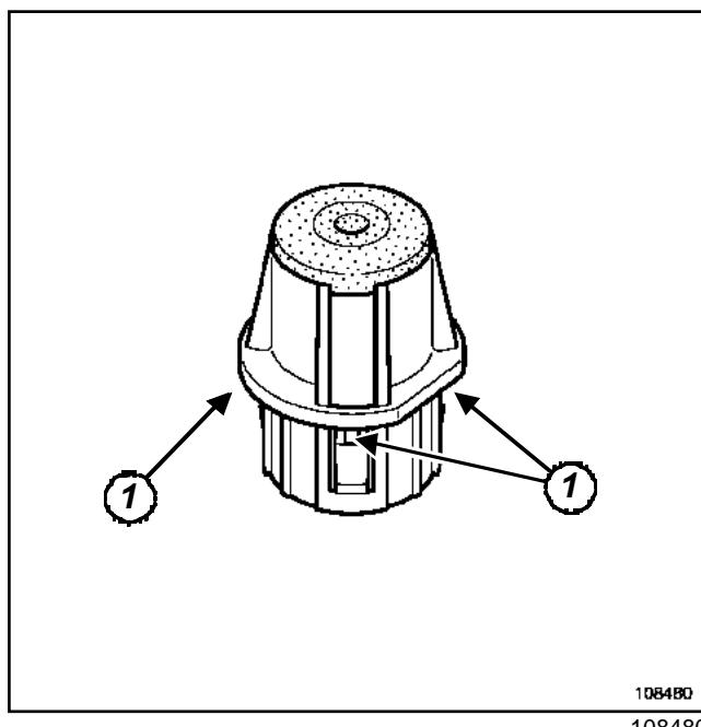
Плоской отверткой нажмите на защелки (1).
