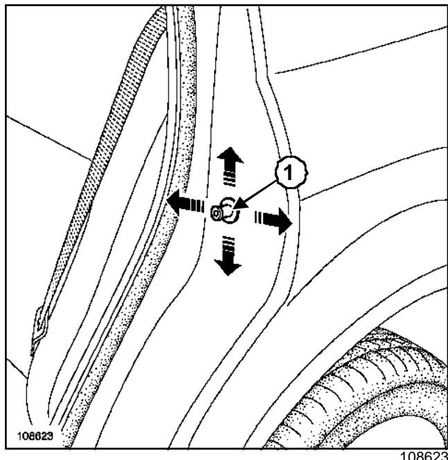
Снимите фиксатор замка двери (1).
