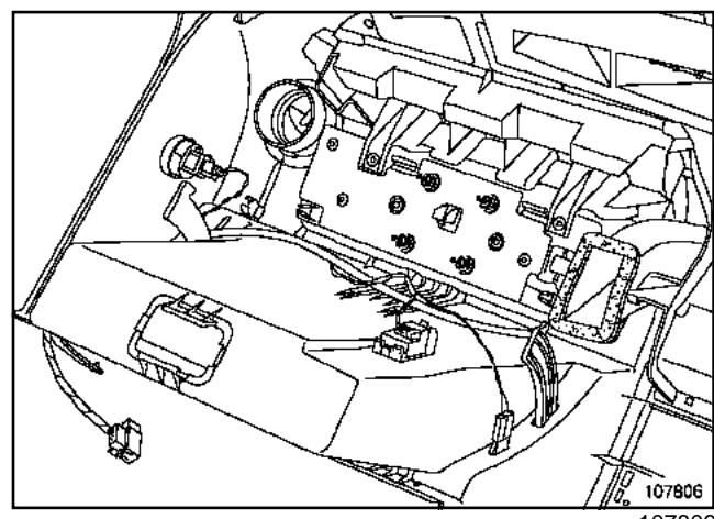
Затяните требуемым моментом гайки крепления подушки безопасности пассажира (8 Н·м))
