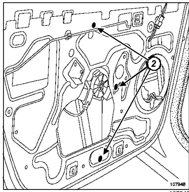
Отверните гайки (2).
