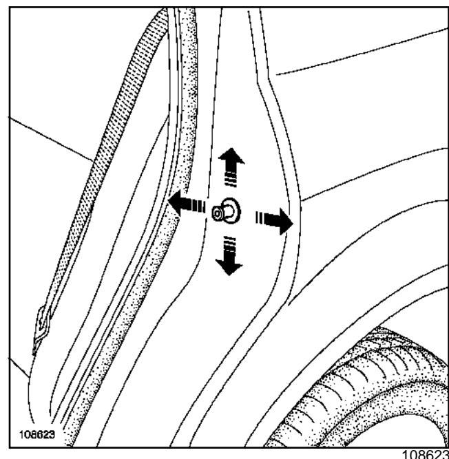
Установите и отрегулируйте фиксатор замка двери.
