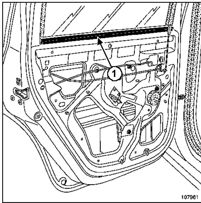
Снимите внутренний подоконный уплотнитель (1).
