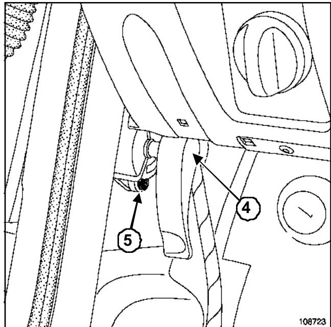
Снимите рукоятку привода замка капота (4).
