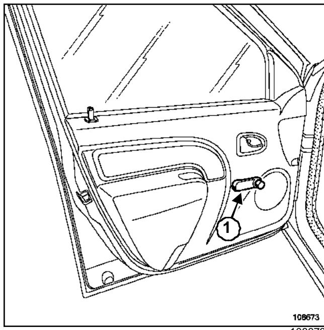
Снимите ручку стеклоподъемника (1) с помощью щипцов для снятия держателей обивок и облицовок.
