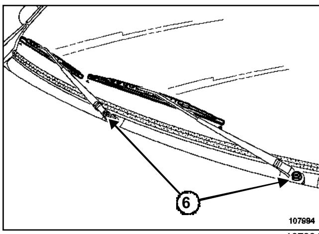
Отверните гайки (6).
