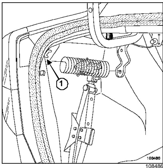
Снимите оттяжную пружину держателя (1).
