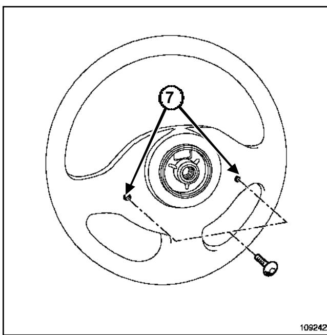
Выверните винты (7) крепления модуля подушки безопасности, используя ключ торкс на 30).
