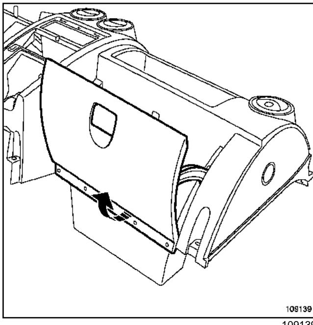
Снимите крышку вещевого ящика
