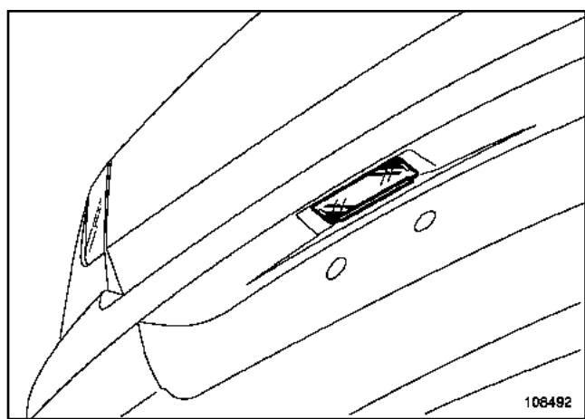
Снимите фонарь освещения заднего номерного знака.
