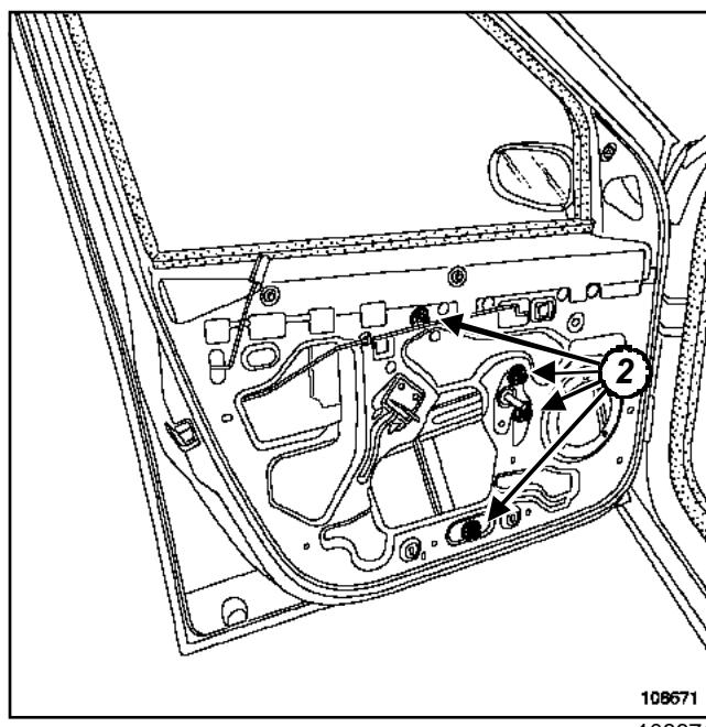
Отверните гайки (2).
