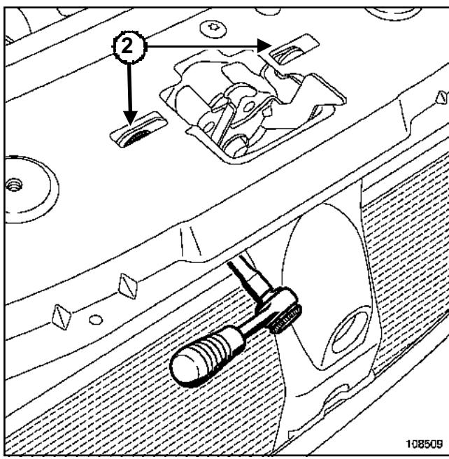
Отверните гайки (2).
