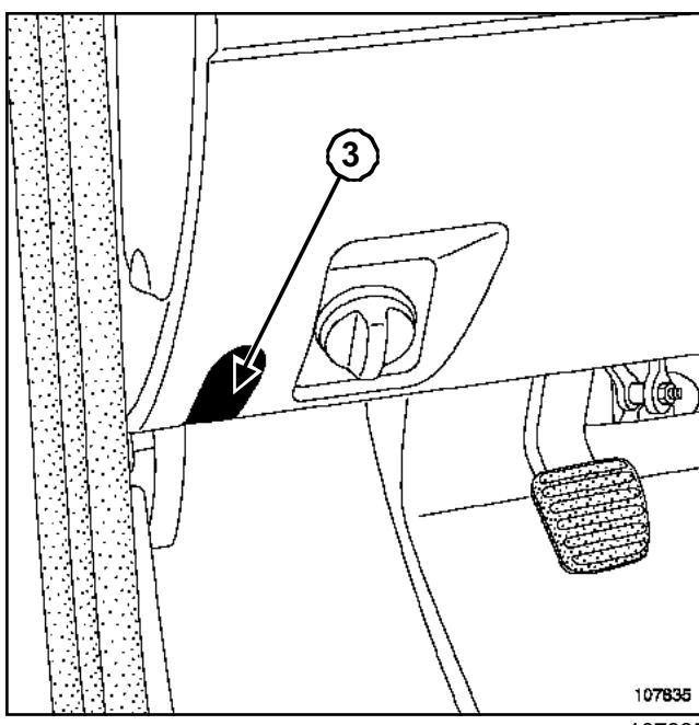
Снимите заглушки(3) с каждой стороны приборной панели.
