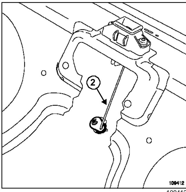
Снимите тягу (2) цилиндра замка.
