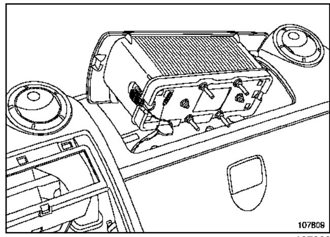
Снимите приборную панель (эта операция выполняется вдвоем с помощником).
