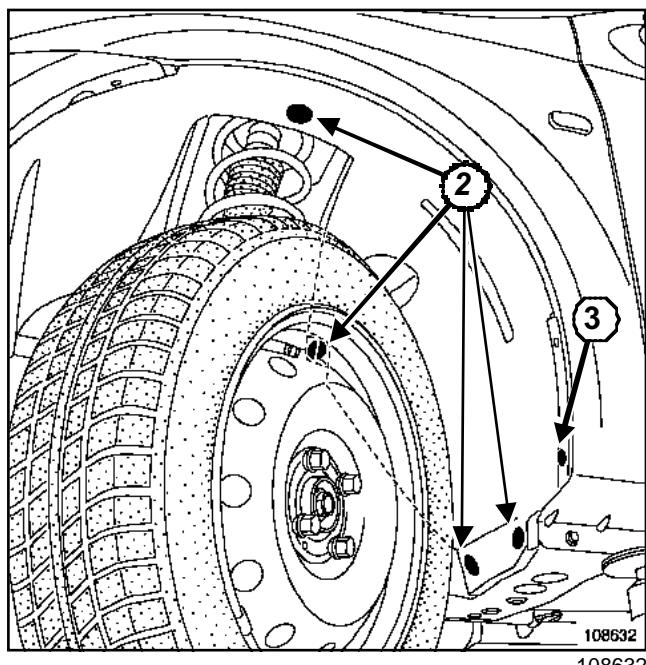
Снимите защелки (2) и (3) фиксаторы крепления подкрылка.
