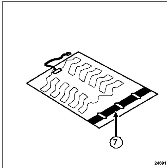
Снимите защитную пленку(7) с нагревательного элемента.
