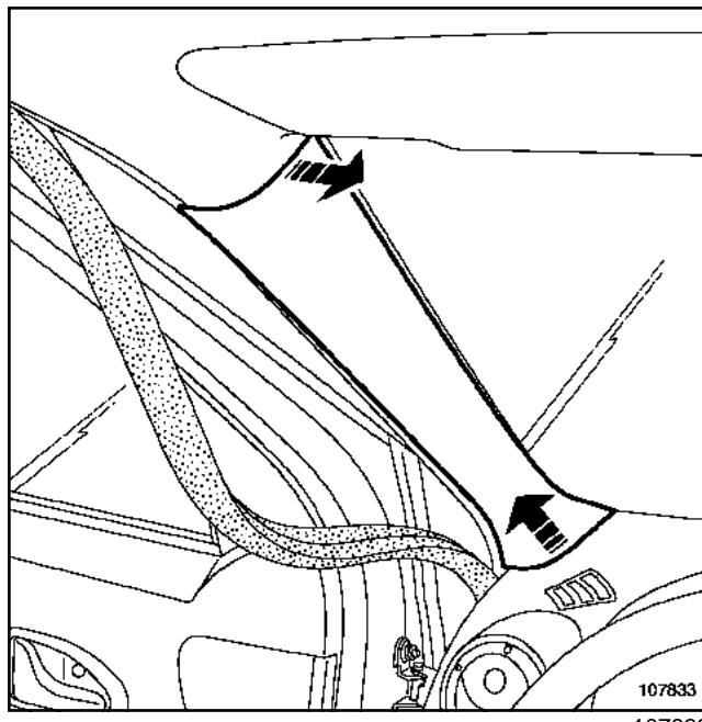
Снимите облицовки стоек проема ветрового стекла.
