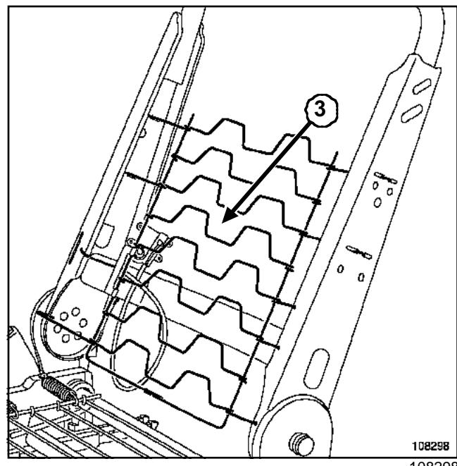
Снимите комплект пружин (3).
