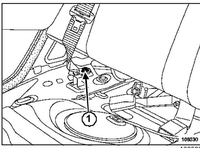
Отверните болты (1) крепления ремней безопасности.
