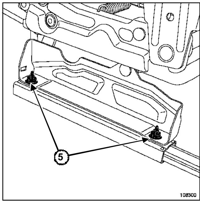
Отверните с каждой стороны гайки (5) крепления салазок сиденья.
