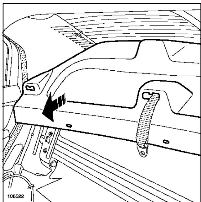
Снимите обивку задней полки.
