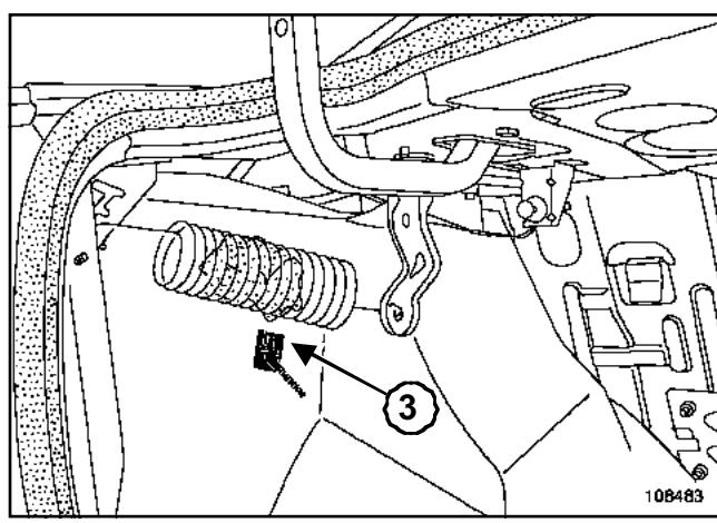
Снимите держатель (3), повернув его против часовой стрелки на четверть оборота.
