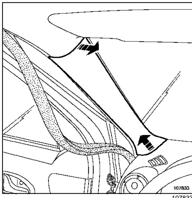
Снимите облицовку стойки проема ветрового стекла.
