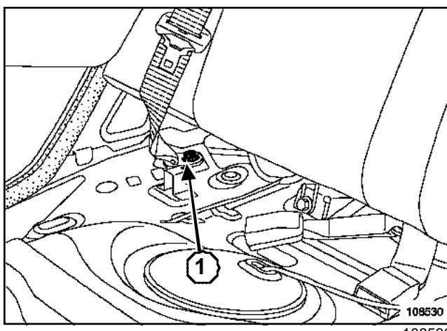
Отверните болты (1) крепления ремней безопасности.
